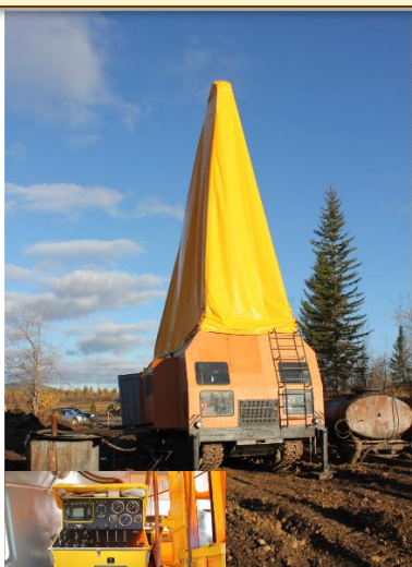
Проходка скважин КБ буровыми станками Christensen CS-10
